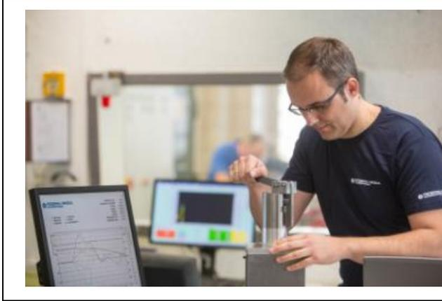
Un banco de ensayos de válvulas desarrollado por Federal-Mogul Powertrain que permite el accionamiento de una única válvula y la evaluación de procesos de cierre individuales.
